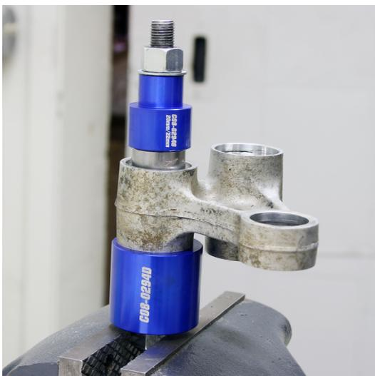
**e.** Installare il cuscinetto sul trascinatore corrispondente come mostrato in Fig 6. Il trascinatore manterrà gli aghi allentati in posizione durante l'installazione.
