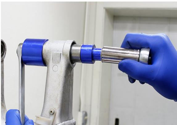
**g.** Assemblare il driver del cuscinetto come mostrato in Fig 4. Serrare la vite fino a quando il driver non tocca la superficie interna del cuscinetto.
